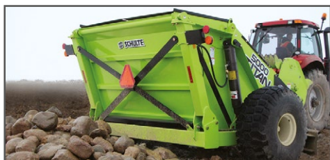
Uložení výložníku umožňuje vykládat kameny do výšky téměř dvou metrů
