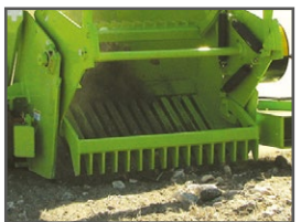
Standardní rošt s roztečí 38 mm a podávací rotor
