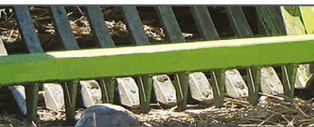
Robustní rošt a podávací rotor je vyroben z extra odolné oceli 450 BHN
