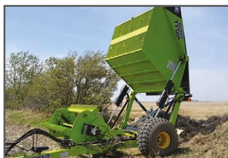
Uložení výložníku umožňuje vykládat kameny do výšky téměř dvou metrů
