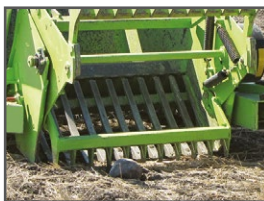
Rošt s roztečí mezi žebry 82,6 mm a podávací rotor
