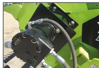
Přímý pohon rotoru hydromotorem přes spojku eliminuje rázy.
